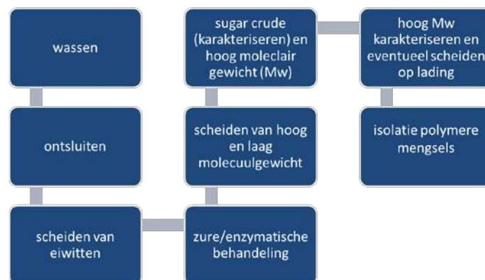
Figuur 3-1 Processtappen voor de verwerking van niet-gescheiden reststromen.
